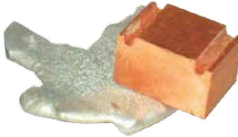
*Dé en laiton à côté d'un bloc de cuivre et de zinc fondu*
