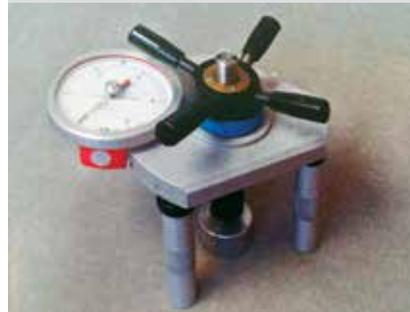
*Appareil pour mesurer la résistance du sol ou de l'ancien revêtement à la traction.*
