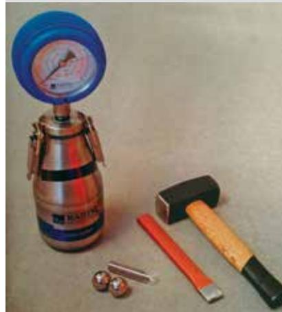
*Appareil pour mesurer l'humidité du support en profondeur*
