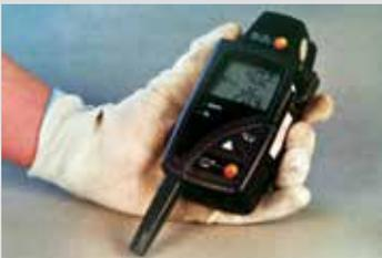
Mesure de la température du support et de l'humidité relative de l'air afin de définir le point de rosée.
