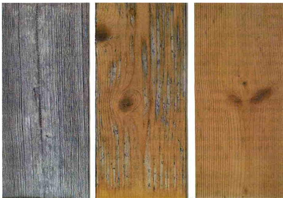
A gauche: bois non traité. Au centre: deux couches de lasure incolore acrylique (60 microns secs) avec adjonction de produits fongicide et hydrofugeant. A droite: imprégnation de la lignine, puis deux couches de lasure incolore acrylique. Exposé environ cinq ans en extérieur avec une inclinaison de 45 degrés, orientation Sud-Ouest.
