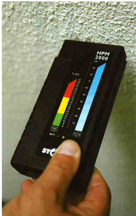
Un appareil simple, pourvu d'une graduation claire, permet de mesurer l'humidité.
